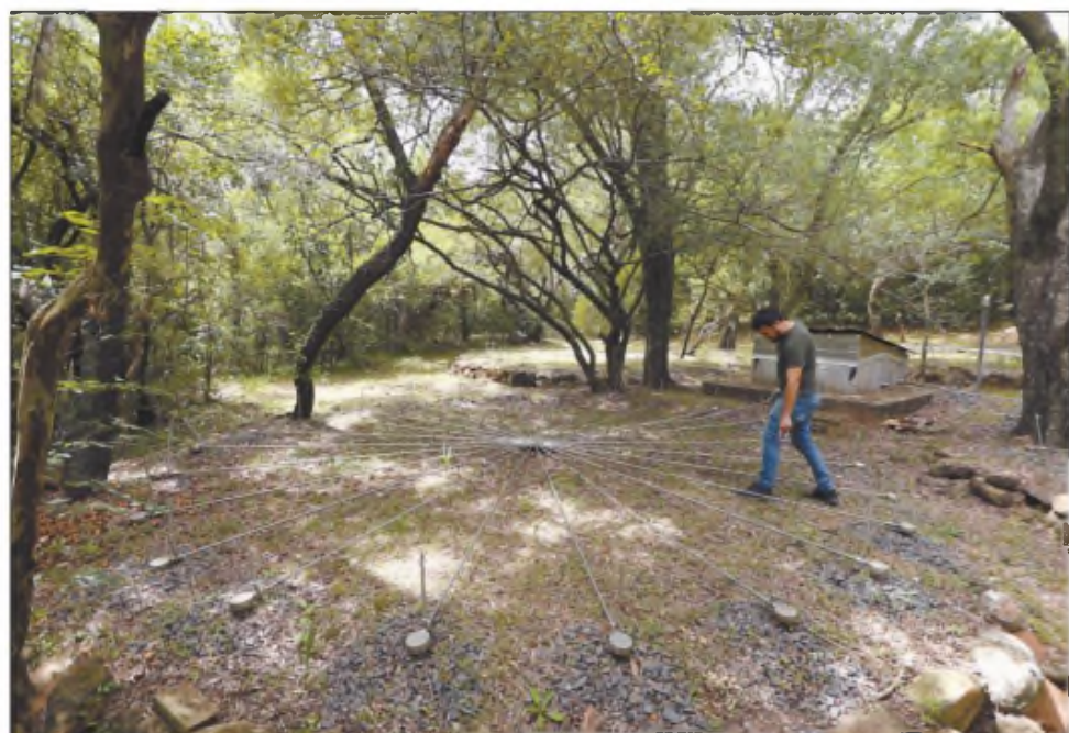
Cada pata del dispositivo de infrasonido es un micrófono que envía la información de las ondas de la atmósfera al núcleo
