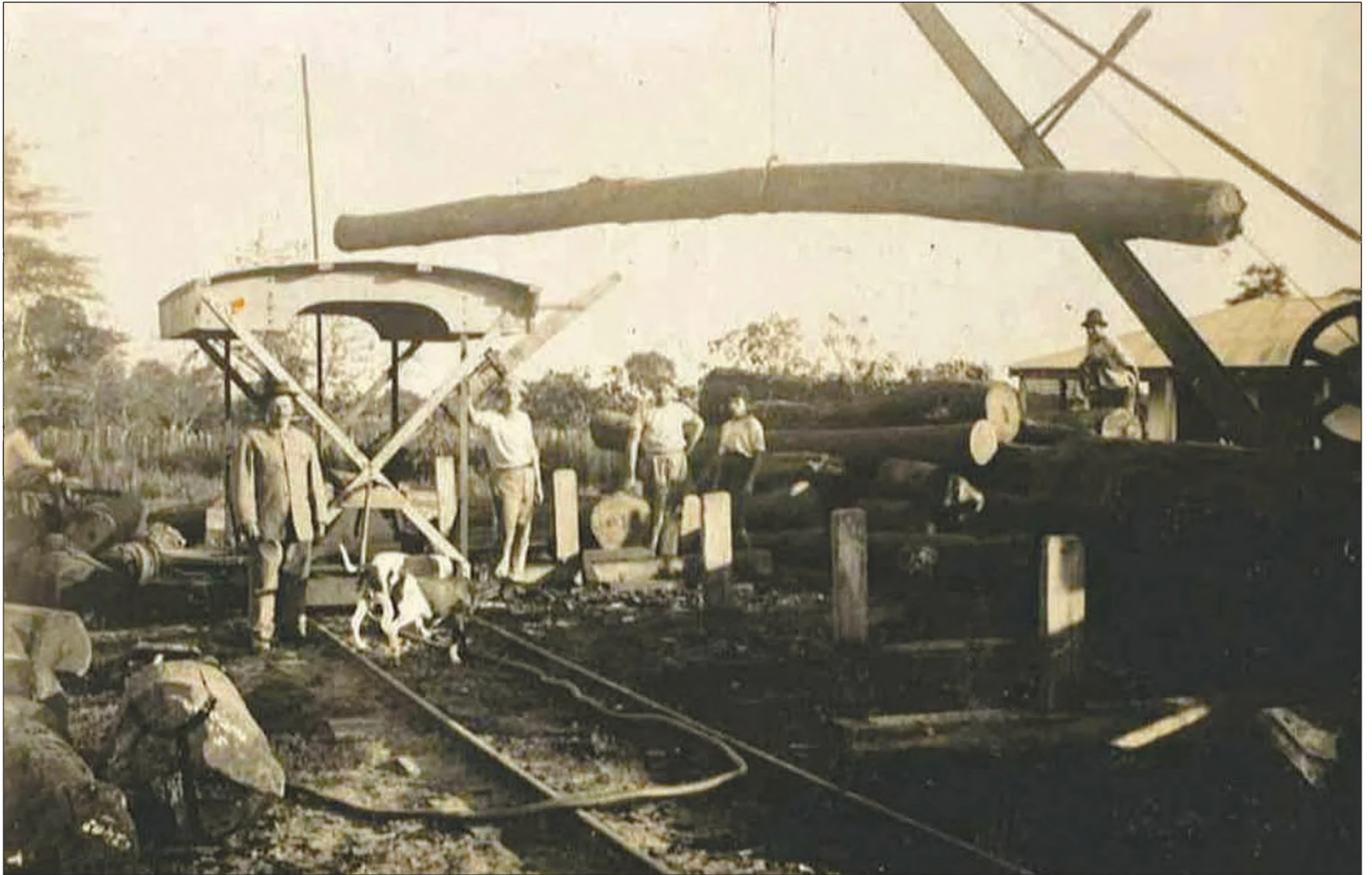
Maquinaria a vapor para despuntar y trocear la madera en Puerto Ybapobó (1922)
