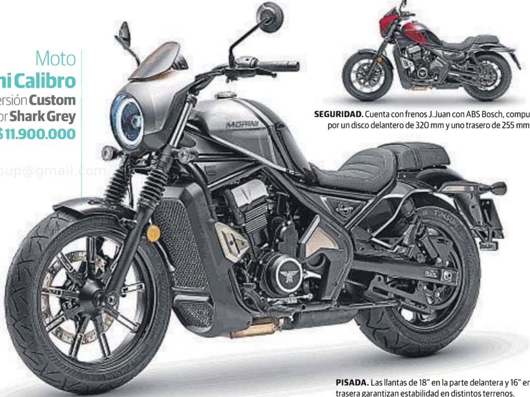
**SEGURIDAD.** Cuenta con frenos J. Juan con ABS Bosch, compuesto por un disco delantero de 320 mm y uno trasero de 255 mm.
