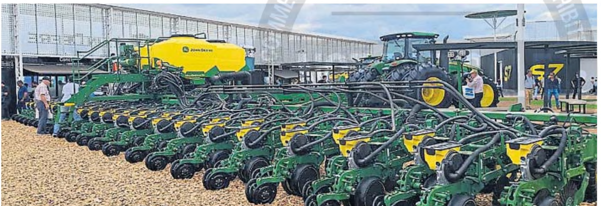
CAPACIDAD DE TRABAJO. La empresa John Deere presentó una sembradora de 43 cuerpos de siembra a 52 centímetros entre líneas. Un potente tractor, el JD 8400R de la marca del ciervo de 400 HP, la conduce.
