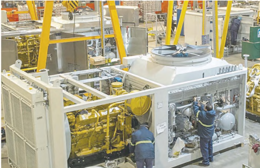
Aspro, firma subsidiaria de Inverlat, produce compresores de gas que se utilizan en boca de pozo en Vaca Muerta
