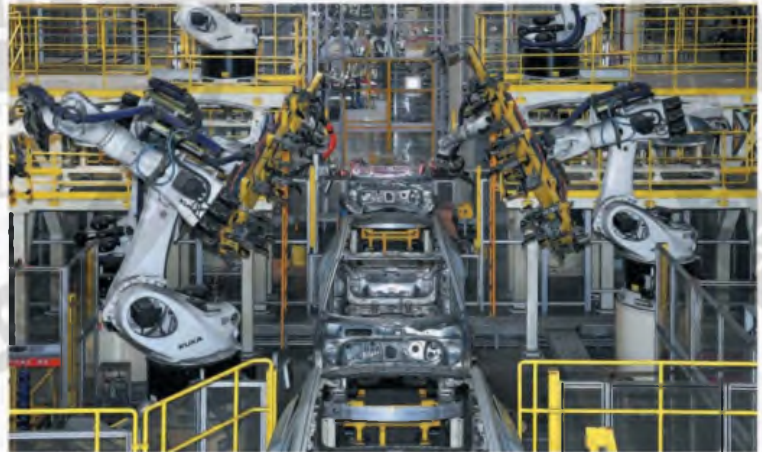
Una línea de soldadura automatizada opera en la planta del fabricante de automóviles chino Geely en Baqi, provincia de Shaanxi. ZOU JINGYI / XINHUA
