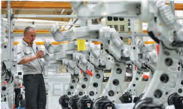
Un técnico ensambla y ajusta robots de soldadura en la fábrica de Panasonic Welding Systems (Tangshan) Co en la provincia de Hebei. ZHAO LIANG / PARA CHINA DAILY
