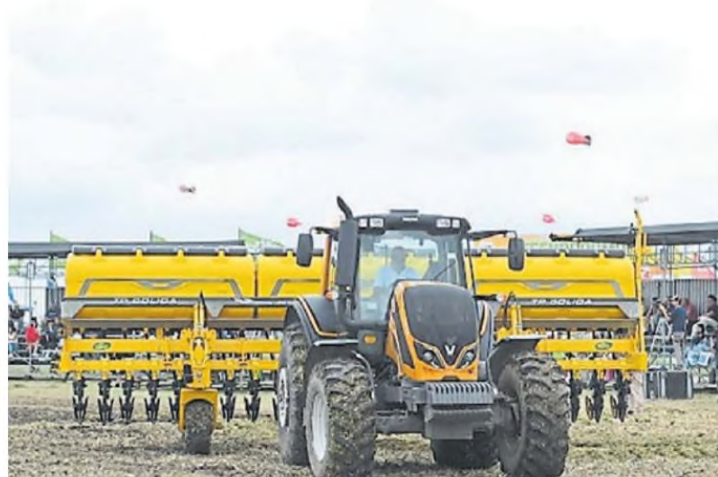
Fertilizadora. Es incorporadora con balanza dinámica para acelerar.
